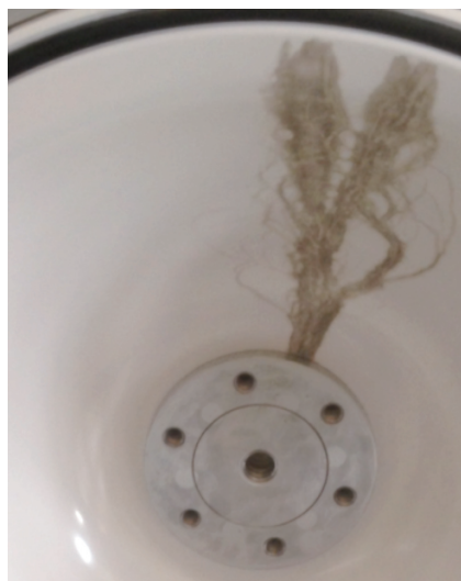
图2 盆式绝缘子表面闪络
