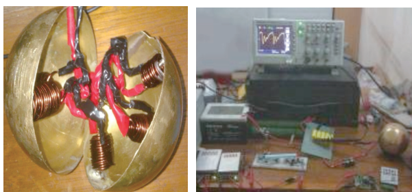
(a) 球形探头内部结构
