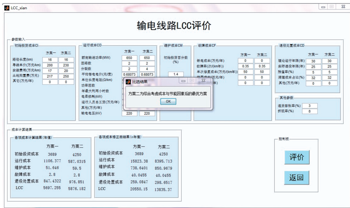
图2 输电线路LCC评价结果
