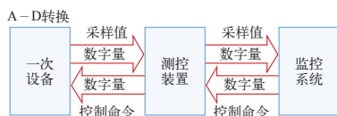
图2 数字化变电站的系统连接图
