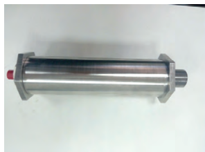
图4 耐高压密闭气室外观
