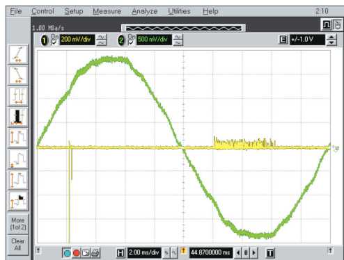
图2 实测空气中电晕放电PD信号
