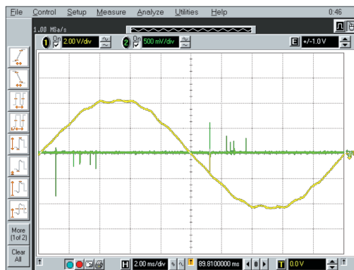
图4 实测油中气隙放电PD信号
