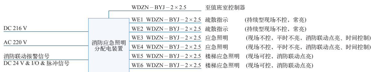
图4 应急照明分配电装置系统
