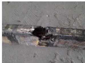
图7 5#给水泵线圈烧熔
