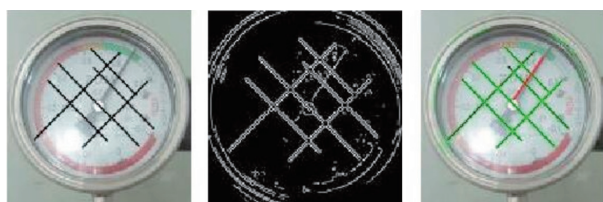
(a) 干扰图像 (b) Canny边缘检测 (c) Hough直线检测
