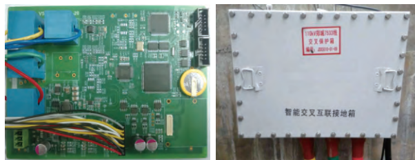
(a) 分析采集板卡 (b) 电缆线路现场挂装设备
