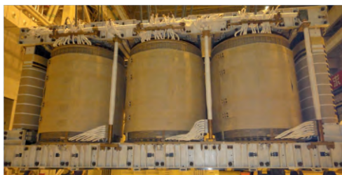
图2 低压铜管引线布置结构
