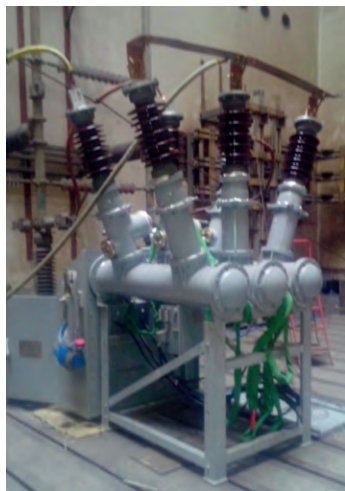
图18 开断试验T100S
