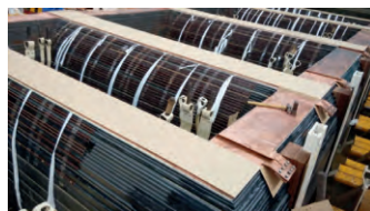
图3 铜补偿环安装效果
