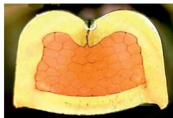
图5 合格压接端子剖面图
