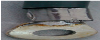
图7 经过灌锡处理的压接端子
