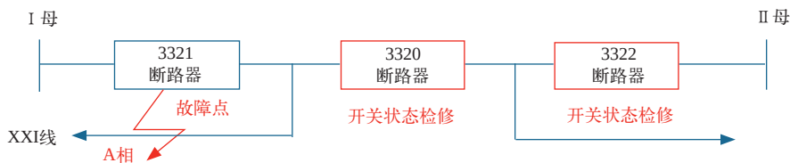
图 变电站某间隔检修状态示意图
