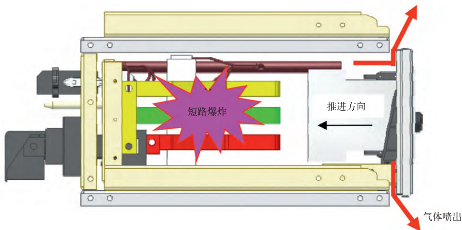
图2 抽屉单元发生故障示意图
