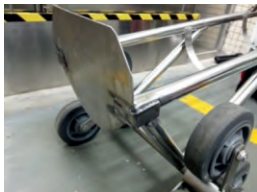
图15 新型搬运小车底板牢固焊接
