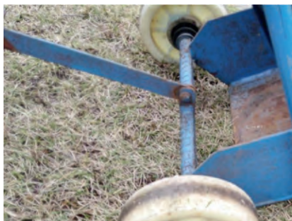
图4 小车结构螺丝生锈
