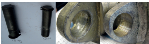
图2 固定销和固定销孔磨损对比图
