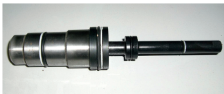
图1 二级管阀密封垫变形
