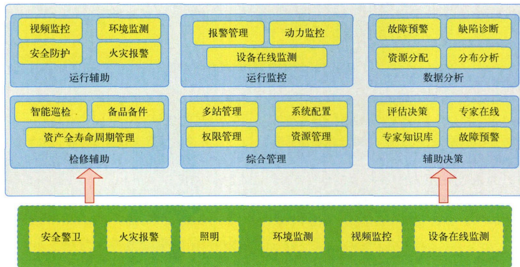
图10 新一代智能变电站辅助系统平台功能架构
