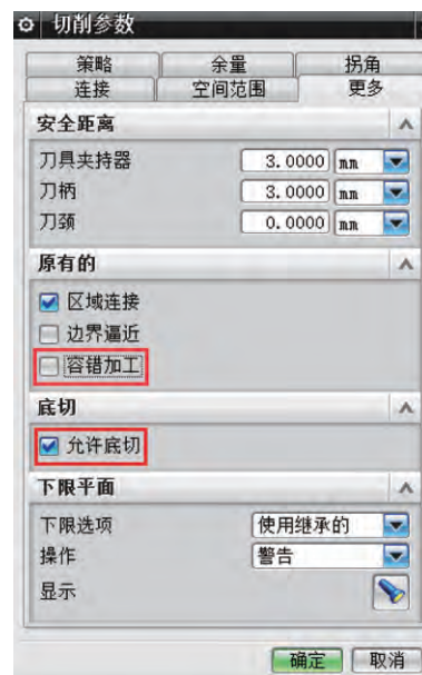
图5 切削参数和设置示意图
