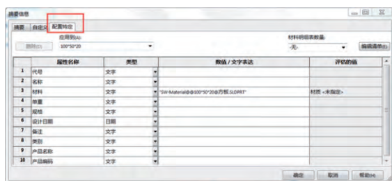
图 9 标准零件需要设定配置特定属性
