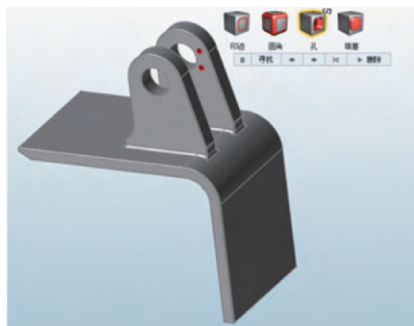
图 3 自动去除孔及凹坑
