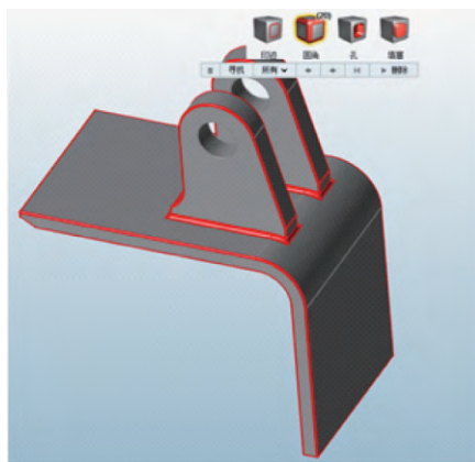
图 4 自动去除圆角及倒角
