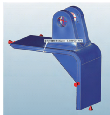
图8 新油缸支座应力云图
