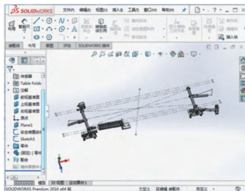
图5 电梯锁紧装置的设计
