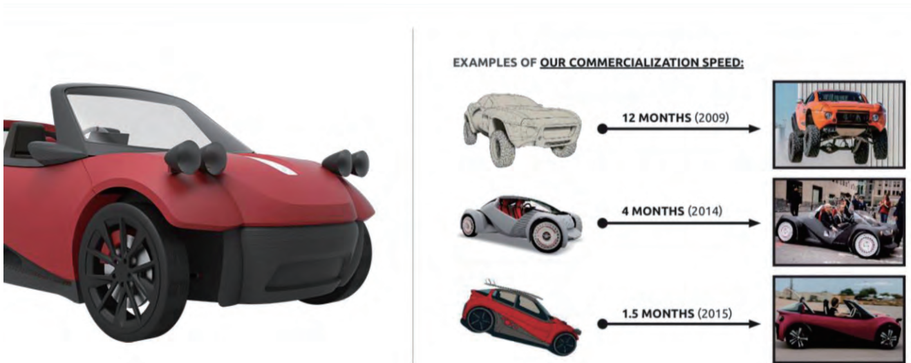
Local Motors 生产的 LM3D Swim 几乎全部零件都通过 3D 打印制成, 这台车的设计生产周期只有一个半月
