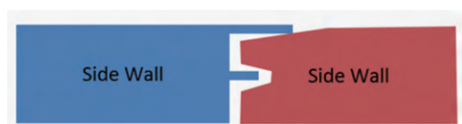
图 7 侧板与侧板的连接示意图
