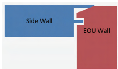
图 6 侧板与端板的连接示意图
