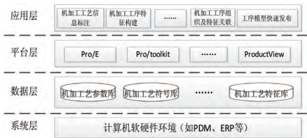
图7 三维机加工工艺设计技术架构图
