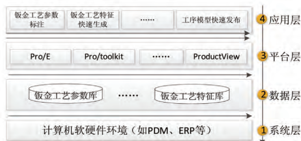
图9 三维钣金工艺设计技术架构图
