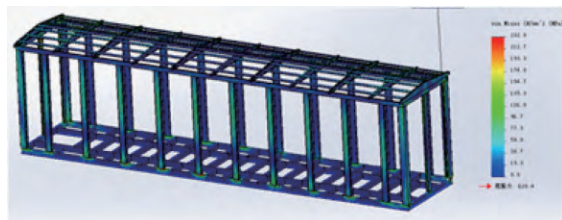
图5 12级风工况下应力云图
