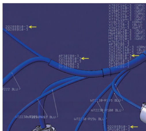
图4 局部三维电气线路和标注
