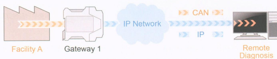
图 3 一个带 Virtual PCAN-Gateway 的 PC 可直接与单个网关通信
