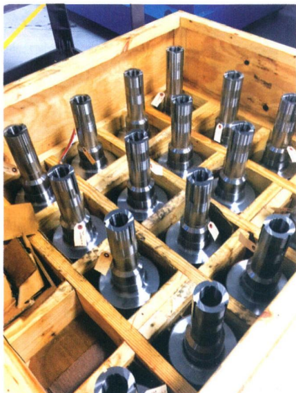
图3 小齿轮等待机床将齿磨深，从而得到小公差和卓越的饰面
