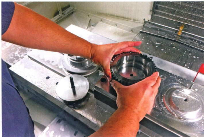
图2 将一个齿轮加载到 Haas VF-2SSYT VMC 上，执行额外加工操作
