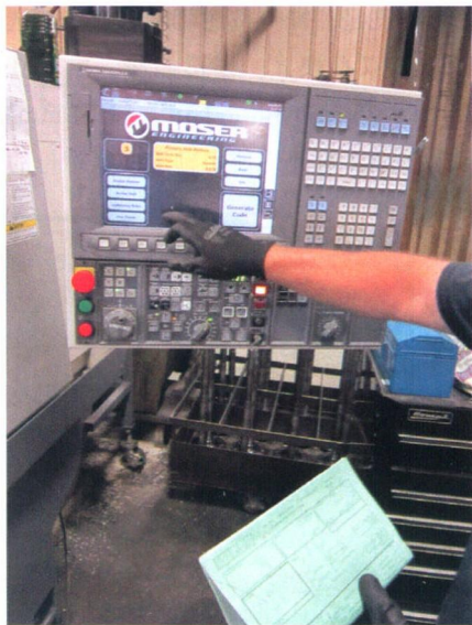
图 3 应用程序的直观图像使用界面，帮助操作者为指定的加工任务选择所有的车轴功能
