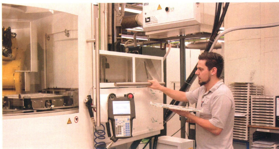
图4 为无人值守生产备好库存：若干个存放坯料和已经加工好的可转位刀片的料盘被安放于料盘系统内
