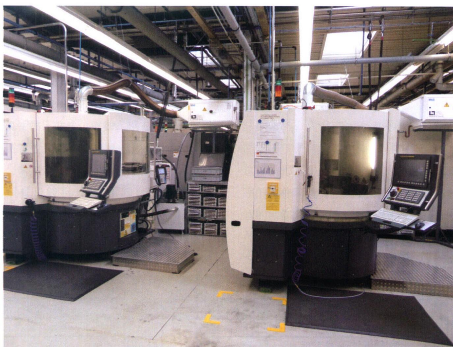
图 1 高效集成：五轴数控全自动化刀片磨床的设计着眼于将生产率和灵活性的完美结合
