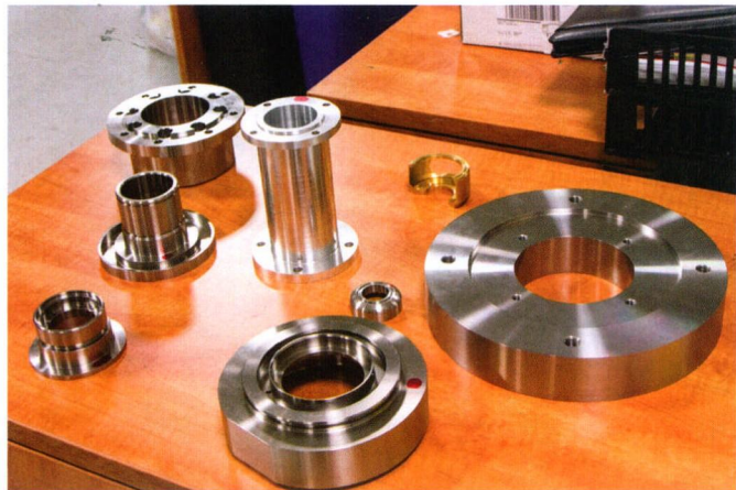
图2 Aztalan 公司在其短期运转的滚轧机中加工各种零件，零件的材料多为不锈钢和铝，但有时也有铜和钛材料
