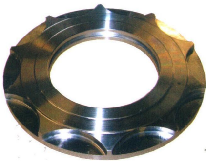
图 3 此处所见的是之前在车床和加工中心上采用单独设置方式进行加工的部分
