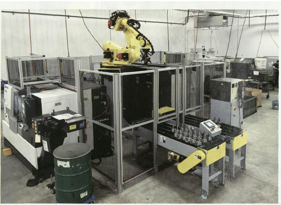
图 1 Gosiger 为 CL Tech 设计的自动化系统采用了发那科 R-2000iB/165R 六轴、基座安装式机器人，放置在两个 Okuma 车床的后面
