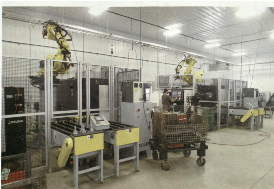
图 2 机器人手臂朝上，放置在 Okuma 车床的后面，使得操作人员能够在不进入机器人工作区的条件下安全地使用机器进行监视和调整
