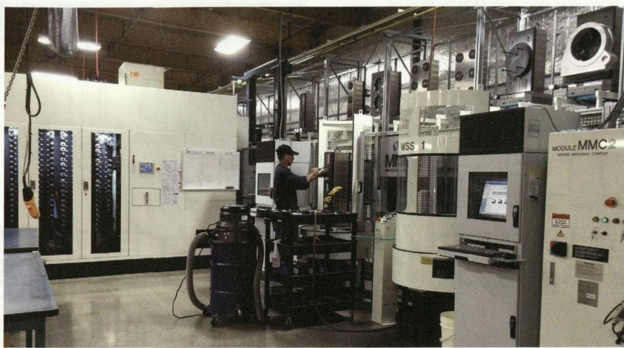
图3 微机械控股公司安装了一套卧式加工中心和托盘系统柔性加工系统,这种自动化有助于公司在只有三名操作人员的情况下,运行其6机生产线
