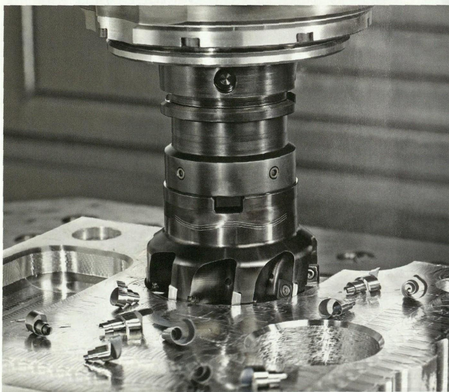
图 1 TDM 被用作对最重要的刀具数据进行管理和配备的中央存储系统。图中所示为带有四刃转位刀片的角铣刀
