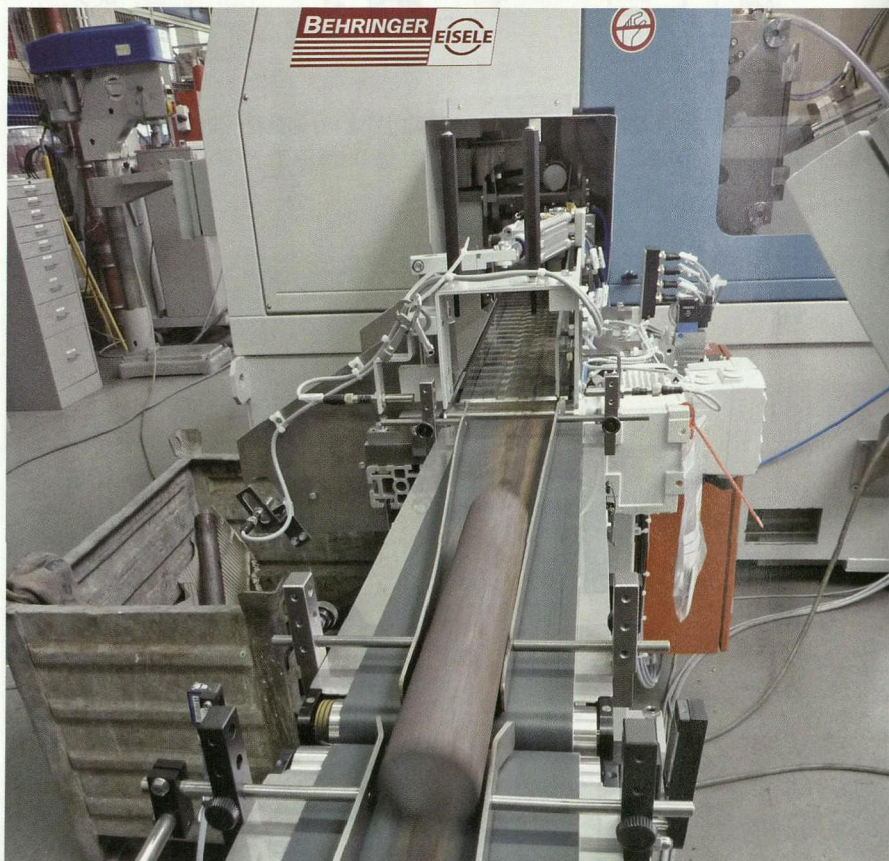
图 1 应客户要求,圆盘锯专家埃塞乐设计了一个由钢棒制备模锻毛坯的锯切组合加工线
