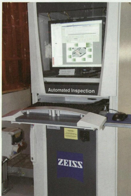
远程办公网络终端可实时查看每一台车的测量数据，实时监控车身质量
