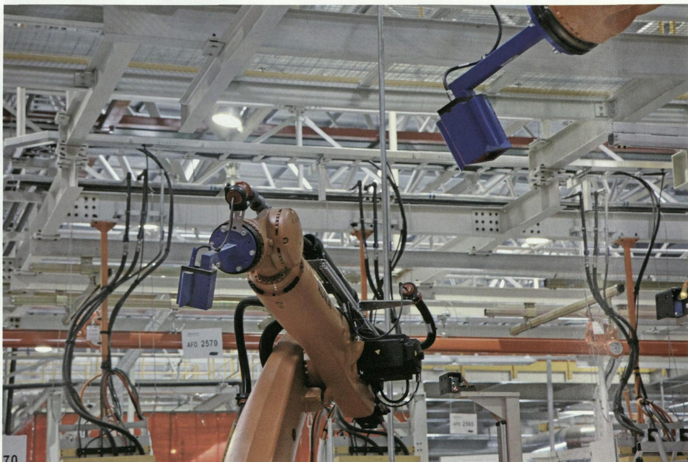
机器人携带测量传感器进行快速移动测量
