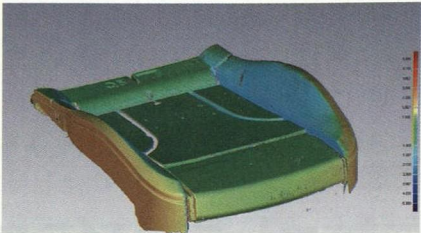
图5 汽车座椅彩图，指示与初始 CAD 模型比较时测试件的偏差量
