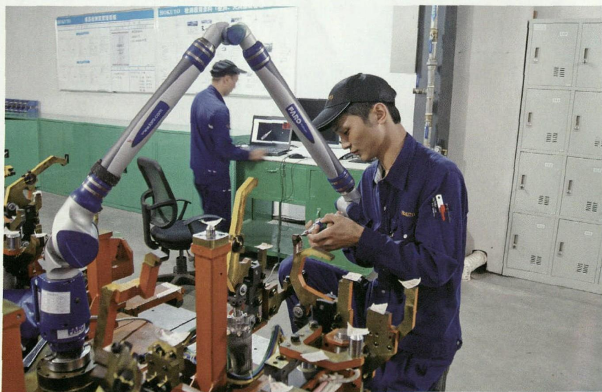
图 2 工程师正在使用精密的便携式 FaroArm® 检测生产夹具
