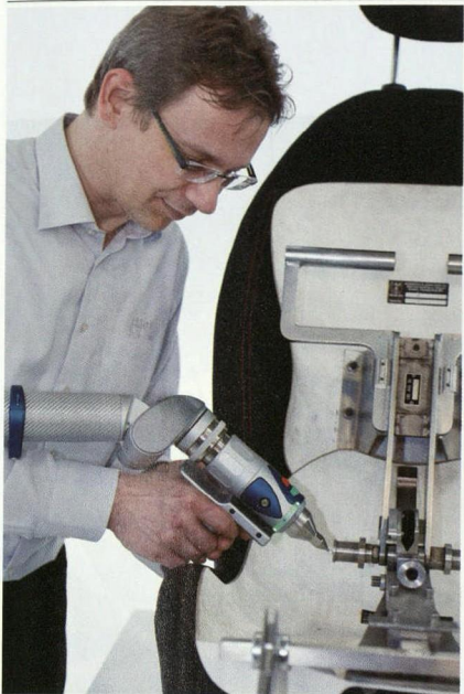
图4 利用关节臂，通过接触测头测量汽车座椅的“臀点”
