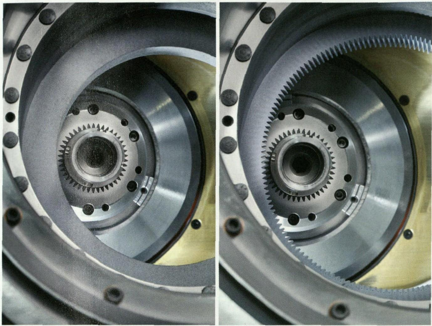
图 2 无齿轮的珩磨环和新的齿轮珩磨环
