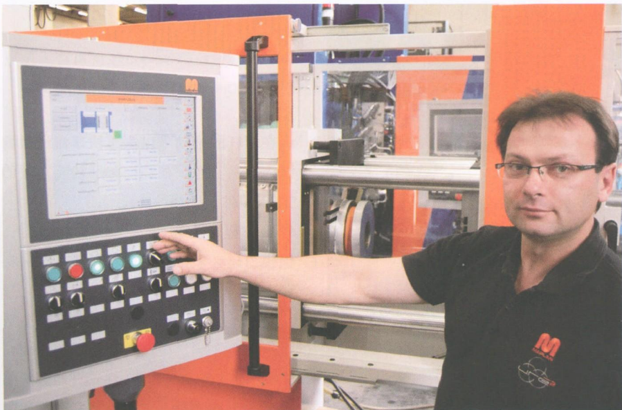
图 3 HMI 应用程序运行在符合人体工程学带 15" 触摸屏的定制化贝加莱 Automation Panel 900 上
