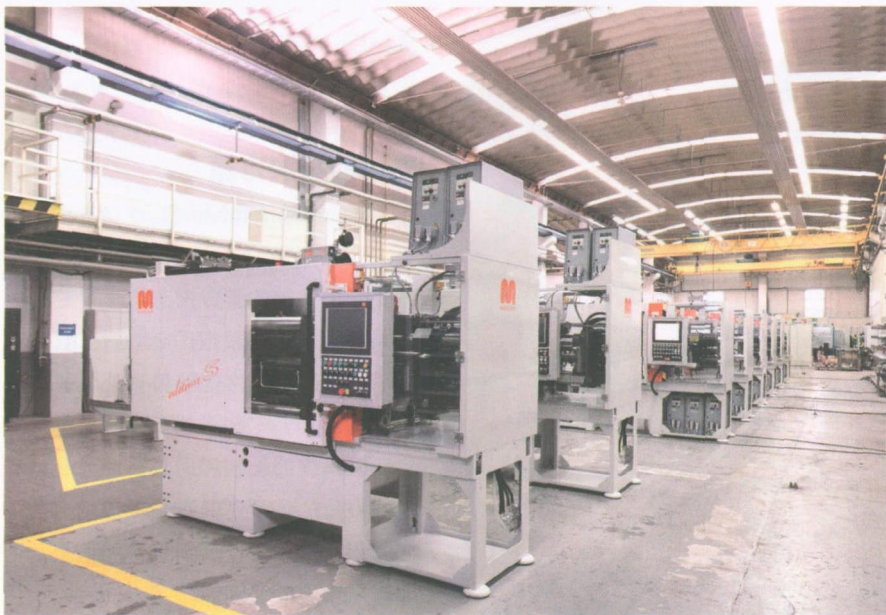
图 1 Maplan 橡胶注塑机可以根据不同的客户规格添加选件，通常在交付前不久进行配置。卧式设计可以最大限度地实现自动化操作，而立式设计则允许手动脱模
