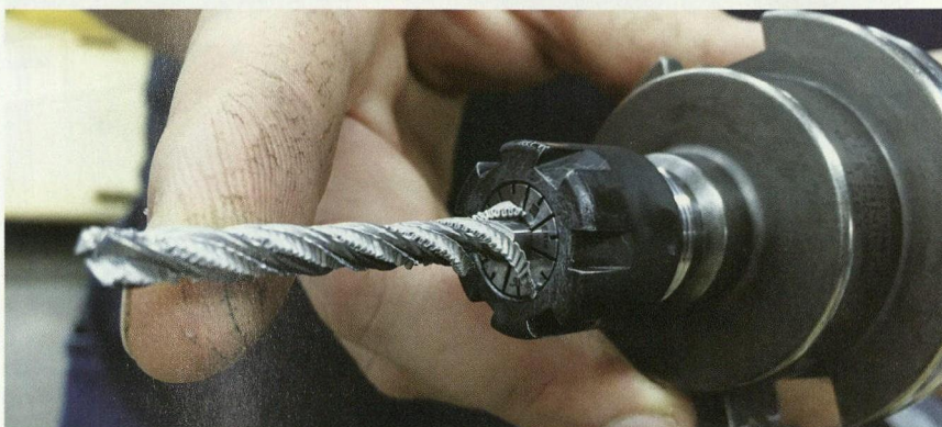
图7 在此情况下，某一钝的钻孔机会造成出屑槽内铝合金的积累，而这种情况在使工具失效或损坏工件之前发现
