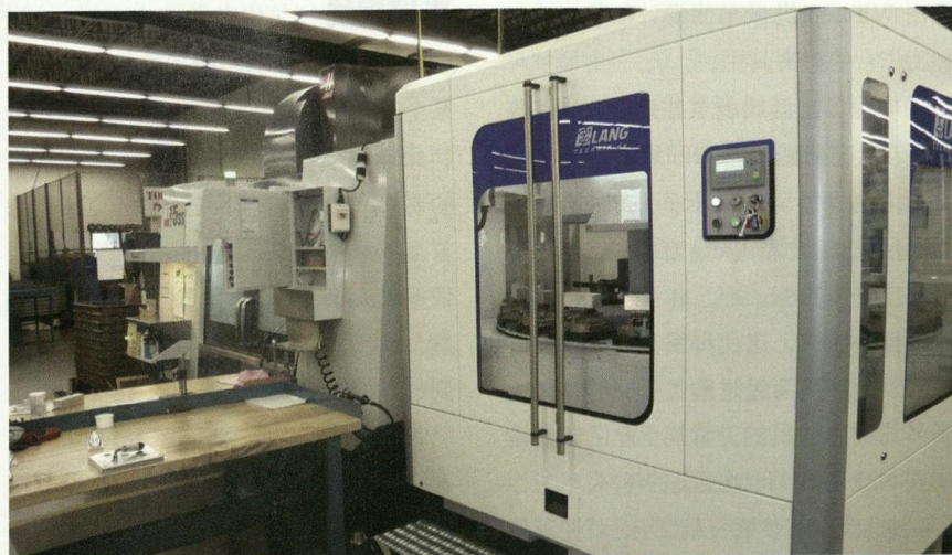
图 2 该 Eco-Compact20 型号为封闭式，其足迹相对较小且仅需 2 根电线就能将其连在机床上。每次最多可同时加载 20 个托盘在传送带上，且零件更换无需使用额外的程序
