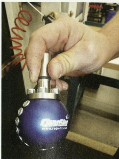
图5 从 Rego-Fix 公司获得的清洁之星“球形冷却剂”和刀库十分吻合，其能通过主轴冷却剂对托盘上的碎屑和机加工后的工件进行清理
