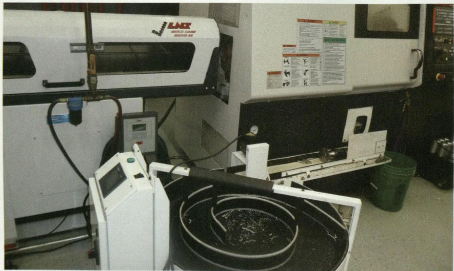
图 4 自动调料进给器和零件抓手实现了 Goodson 多任务设备的无人操作
