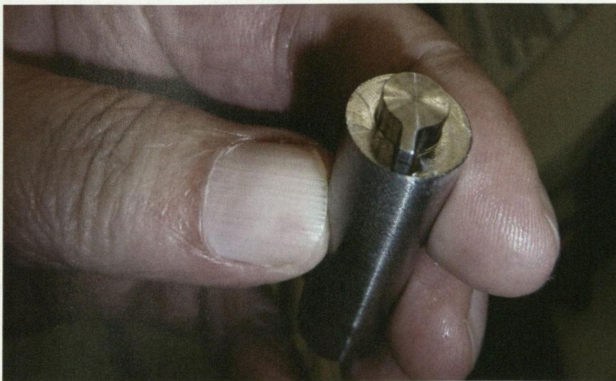
图 2 这个凸轮杆是利用 Integrex，直接使用 4 ft 长的 0.625 in 调料一次组装完成的
