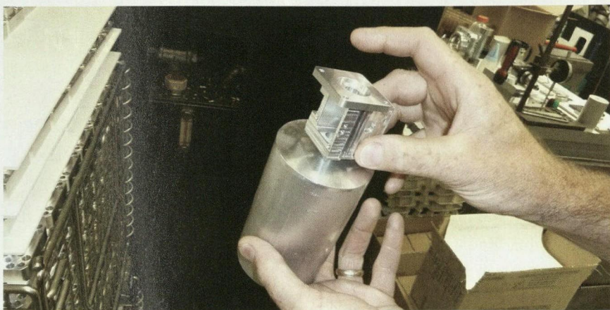
图 3 购买多任务机器前，部分零件（如直角外壳）必须在两台机器上进行多大六次加工。现在，可以直接把它从原料变成成品
