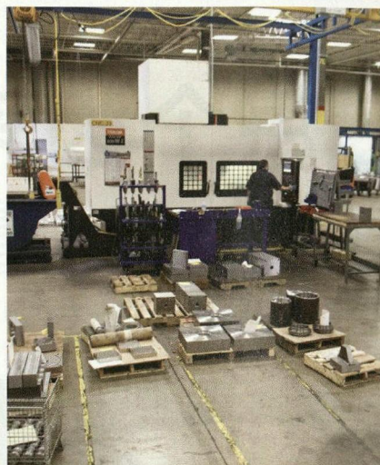
图 3 尽管增加先进机床技术是 Hanna Cylinders 提高产量的一个重大因素，但零件流动重组为简单直线所带来的影响同设备本身一样大
