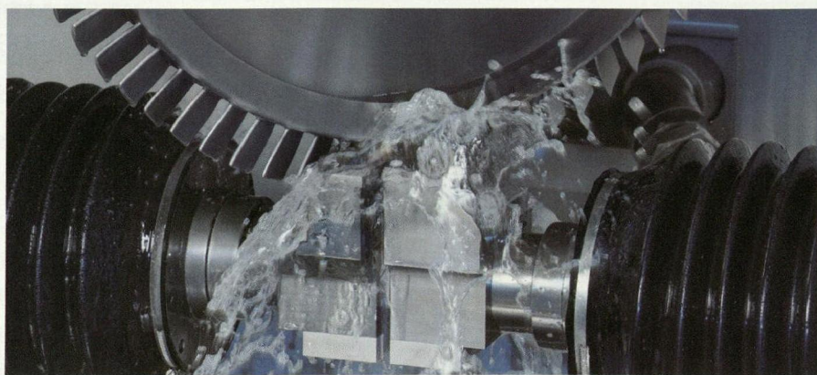
图2 EMAG PO 900 BF的加工区域内,正在使用PECM(精密电解加工)技术加工整体叶盘
