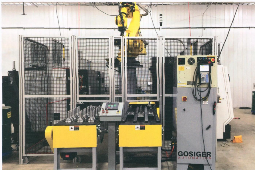
图 3 操作人员手动连续将 40 个粗糙工件按照随机径向取向放置在钢制平顶来料传送机上，机器人拾起零件，使用摄像头确定工件朝向，然后将零件装入第一个车床
