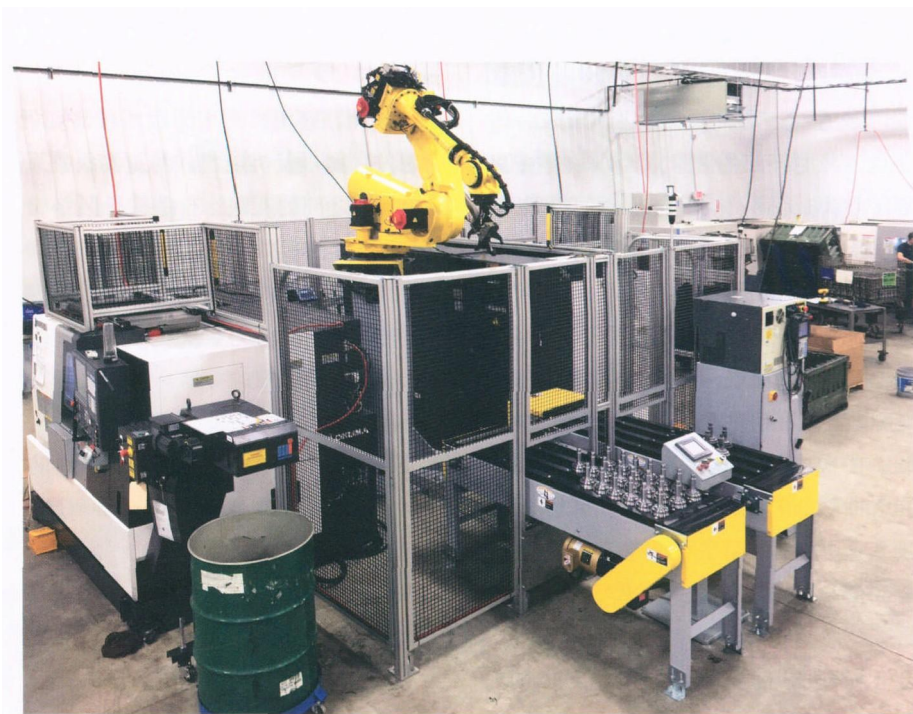
图 1 Gosiger 为 CL Tech 设计的自动化系统采用了发那科 R-2000iB/165R 六轴、基座安装式机器人，放置在两个 Okuma 车床的后面
