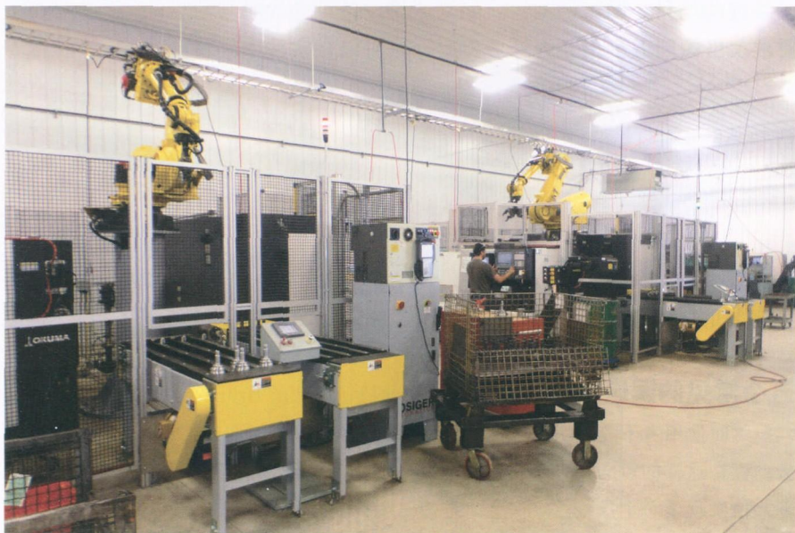
图 2 机器人手臂朝上，放置在 Okuma 车床的后面，使得操作人员能够在不进入机器人工作区的条件下安全地使用机器进行监视和调整
