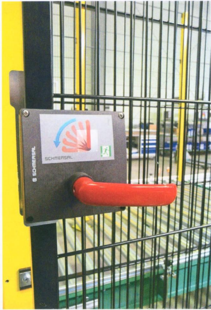
图 3 安全门的逃生锁门不允许在外面能够轻易够到
